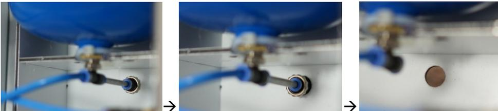
4. Die Schlauschelle lockern und Schlauchstück sowie Scheibe ungefähr in die Mitte schieben.
