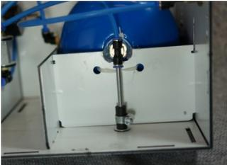
Die Schlauchschelle mit einem geeigneten Schraubendreher festziehen.
